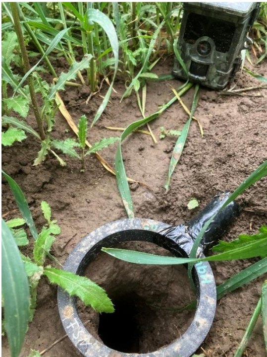
Abb. 2: Equipment auf dem Feld: RFID-Antenne über dem Eingang zu einem Bau und zusätzlich eine Wildkamera, die das Verhalten des Bewohners aufzeichnet.
