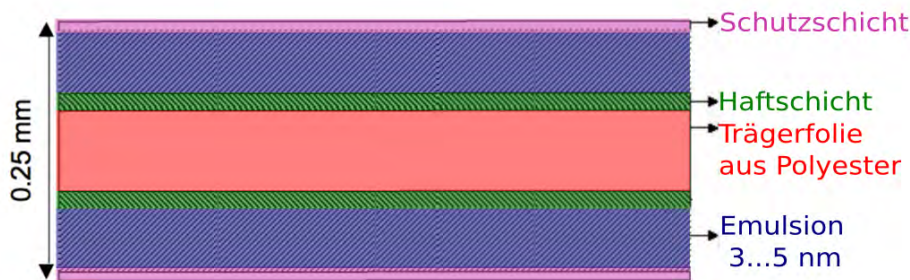
Abb. 2.7.: Schematische Darstellung eines Röntgenfilms und seiner einzelnen Schichten.
