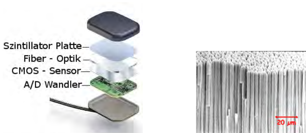
Abb. 2.8.: Schematische Darstellung eines digitalen Bildsensors, bei dem die Röntgenstrahlung durch die schwarze Abdeckung einfällt, in Lichtphotonen gewandelt wird, von der Faseroptik gebündelt wird und im CMOS-Sensor pixelweise elektrische Signale an den A/D-Wandler sendet um hochauflösende Röntgenbilder zu erstellen (links [14]). Struktur eines Szintillators mit Kristallsäulenstruktur (rechts [15]).
