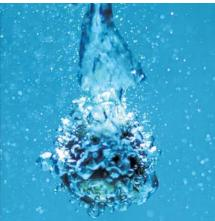
Eine heiße Kugel mit einer stark wasserabweisenden Oberfläche zeigt nur wenig Blasenbildung. Anders eine Kugel ohne Beschichtung (rechts).
