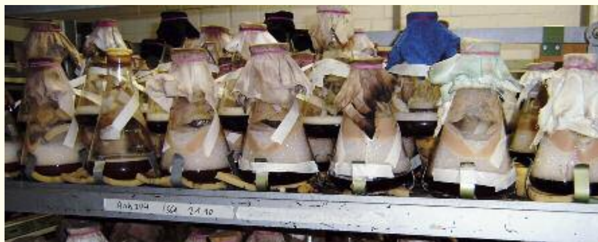
Schüttelkulturen werden im Institut für Organische und Biomolekulare Chemie zur Anzucht von Mikroorganismen genutzt.
