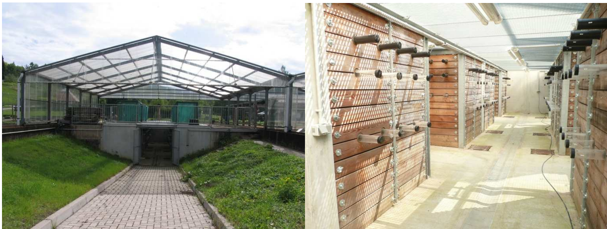
Abb. 10: Göttinger Rhizolab. Links: Ein mobiles Rolldach mit Regensensor schützt die Jungbuchen vor natürlichem Niederschlag und ermöglicht damit die Einstellung kontrollierter Bodenfeuchtwerte. Rechts: Im Kellerbereich der Rhizolabs wird das Wachstum der Baumwurzeln in durchsichtigen Rhizoskopieröhren analysiert, die horizontal in die Pflanzcontainer installiert sind.
