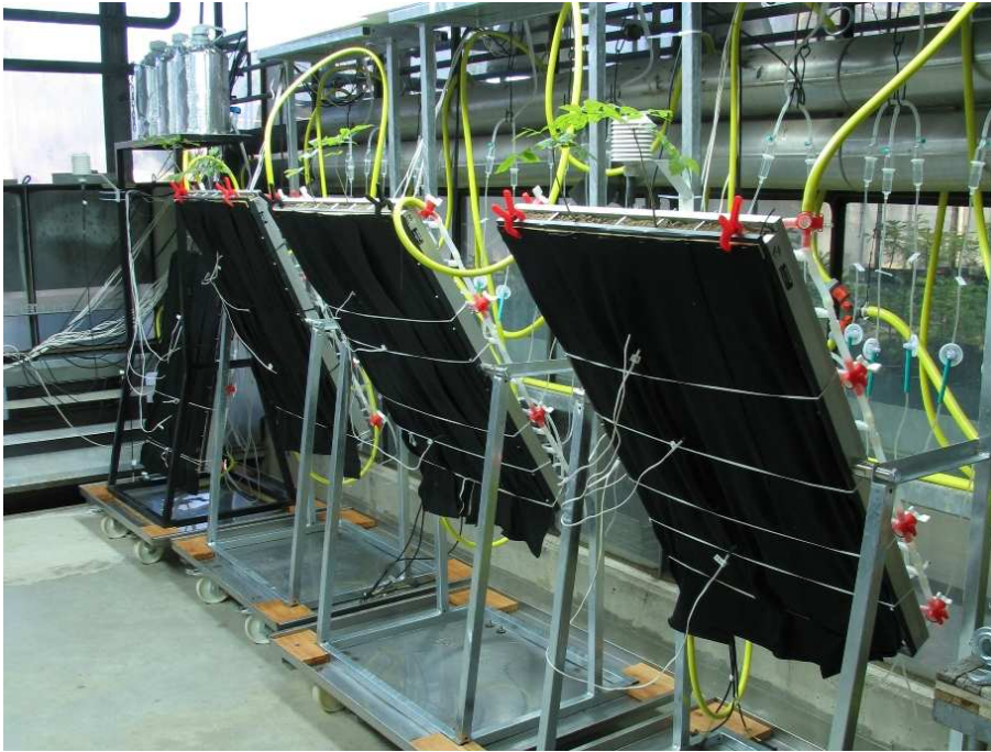
Abb. 1: 'Double Splitroot' Rhizoboxen mit Buchen und Eschenjungpflanzen in einer Klimakabine des Neuen Experimentellen Botanischen Gartens der Universität Göttingen. Alle Rhizoboxen (16 Stück) sind hinsichtlich Bodentemperatur- und -feuchte exakt kalibrierbar und die Pflanzen wachsen unter vergleichbaren Lichtbedingungen. Die Regulierbarkeit der abiotischen Bedingungen – entweder Konstanz oder Einstellung von Temperatur- und Feuchtgradienten im Boden - schafft die Voraussetzung für Biodiversitätsstudien, wie sie im Freiland nicht möglich sind.
