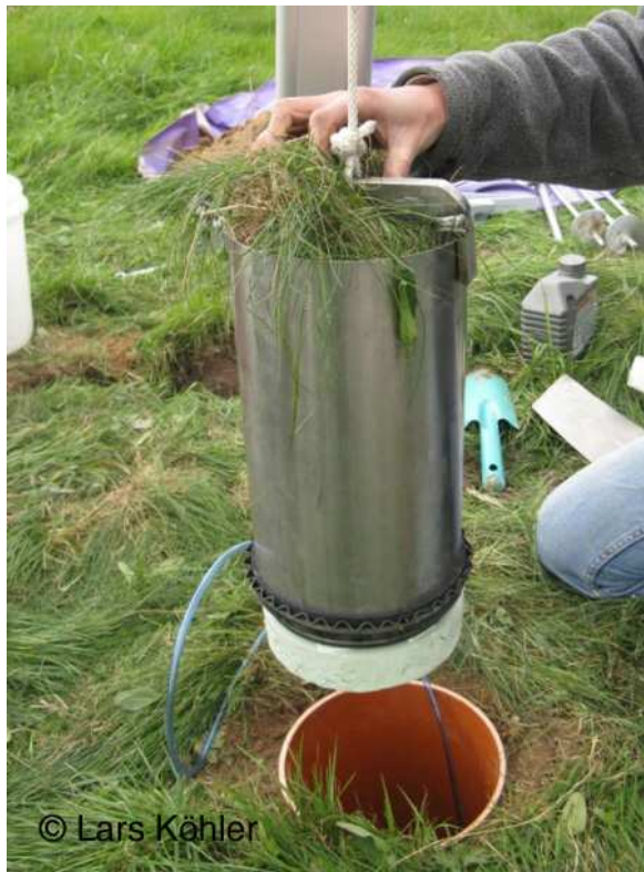
Abb. 4: Installation eines Wäge-Lysimeters zur Bestimmung der Evapotranspiration und der Versickerung des Wassers im Boden.
